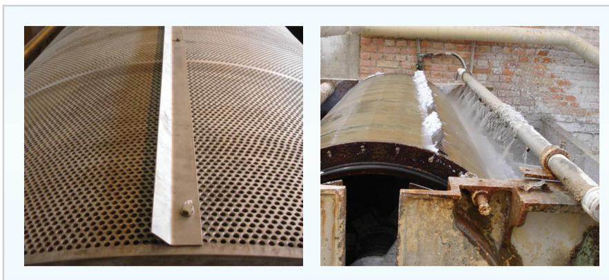
Figura 7: Fixação por régua transversal.
